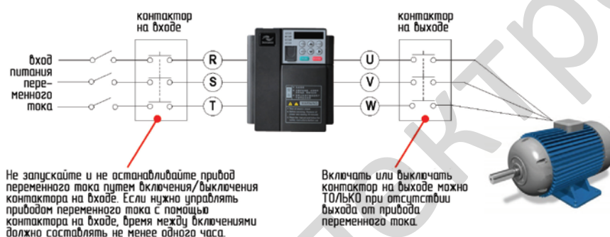
Рис. 1-3. Входные и выходные контакторы
