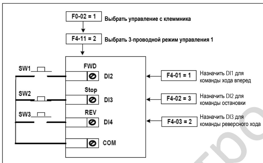
Рис. 6-2. Выбор электромагнитной кнопки для управления пуском/остановкой
